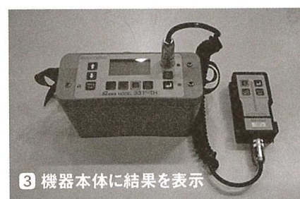
2 電磁誘導法によりかぶり厚さを測定
