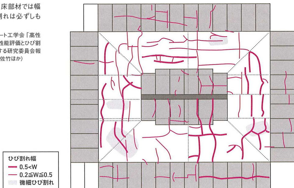
図7 幅 0.5mm 以上のひび割れが床スラブで多発した例
