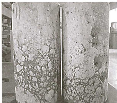
膨張材が過剰に使用されると、膨張ひび割れが生じる場合がある（写真：右も日経アーキテクチャ）
